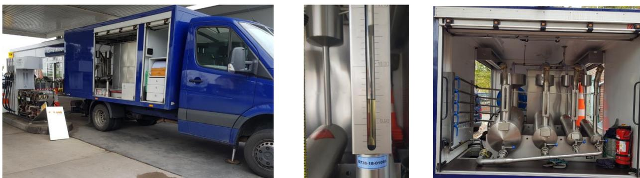
**Abb. 1:** Eichung einer Straßenzapfsäule unter Einsatz von Volumennormalen
