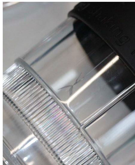
Abbildung 18: Becher nach Schlagprüfung
