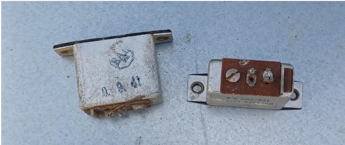
Abbildung 12: Beispiel Radium 226 Fund eines Steckers im Schrott
