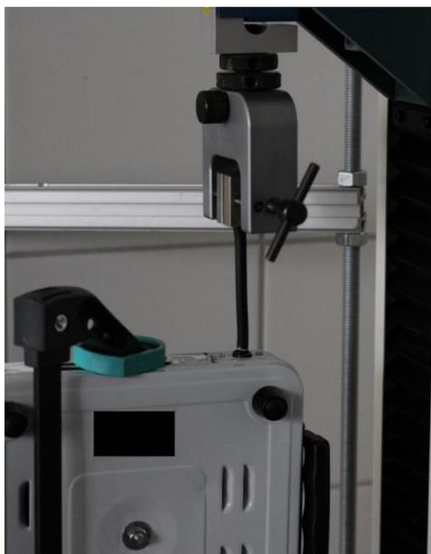
Abbildung 22: Zugprüfung der Netzanschlussleitung an einem Prüfobjekt
