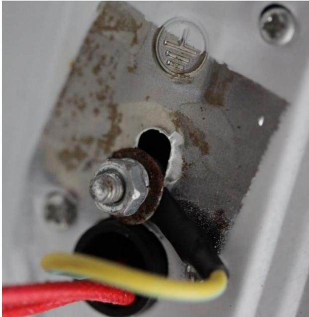
Abbildung 23: Korrosion am Schutzleiteranschluss nach Feuchtigkeitsprüfung
