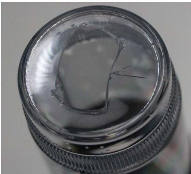
Abbildung 17: : Becher nach Schlagprüfung; Boden gebrochen
